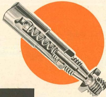
Le graissage « TÉCALEMIT-LUB » est basé sur l'emploi de graisseurs à cuvette et soupape alimentés par des pompes sans flexible fonctionnant par poussée et munies d'un embout de forme sphérique. L'étanchéité est assurée par contact métal sur métal.
